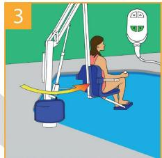
Drehen Sie den Lift so, dass der Sitz über dem Pool ist
